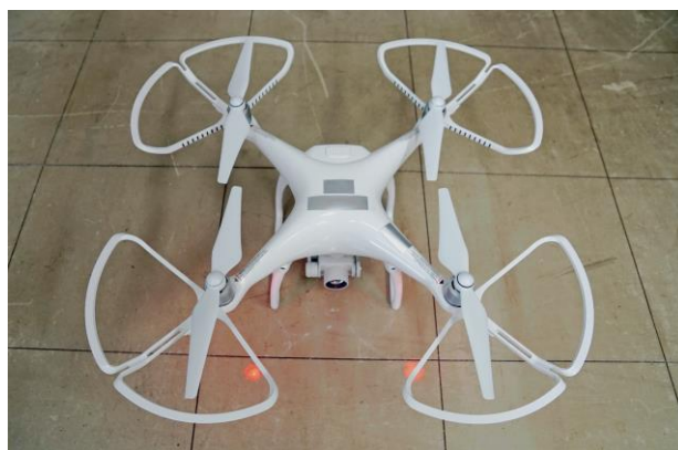
写真3-3 ドローンにプロペラガードを取り付けた状況
