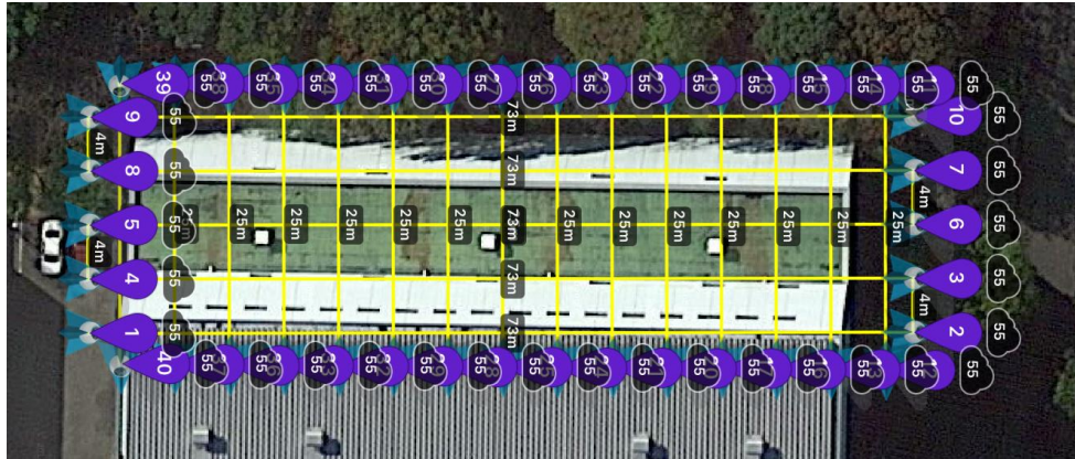
写真 4－3 自動飛行による屋根の確認・点検
