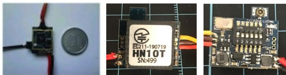
写真 3.3.1 マイクロドローンに組み込まれる 5.7GHz 超小型 VTX
