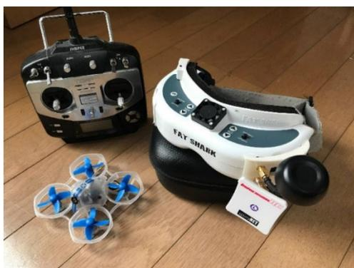
図 3.1.1.1 マイクロドローンの無線構成
