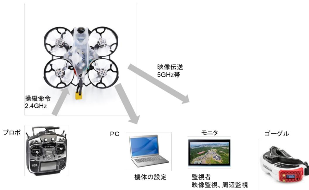
図 2.1.4 マイクロドローンの操縦構成図(例)
